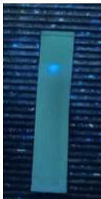
Gambar 4.3 Hasil KLT senyawa isolat 2 di bawah lampu UV 356 nm
